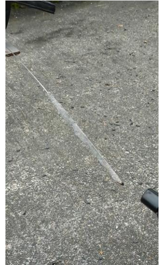
Funkenfackel mit definierten Anteilen von Fe/Al-Partikeln (li.), Abbrand (re.)
