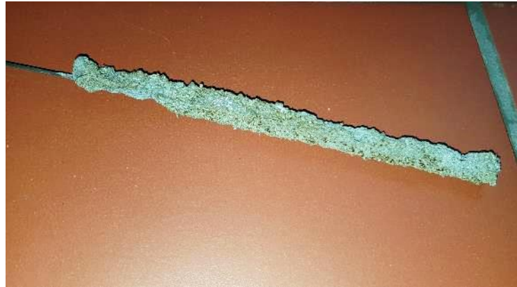
Funkenfackel mit definierten Anteilen von Fe/Al-Partikeln (li.), Abbrand (re.)
